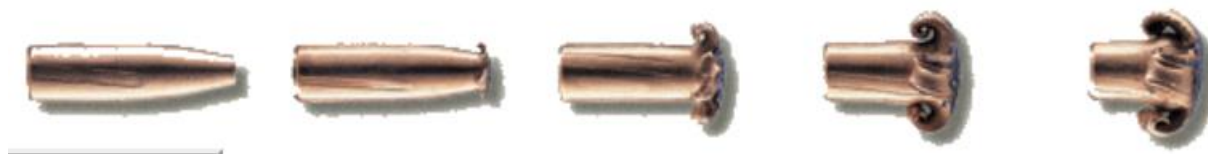
FIGURA 34: DEFORMAZIONE IDEALE DI UN PROIETTILE QUANDO PENETRA ALL'INTERNO DI UN ANIMALE
